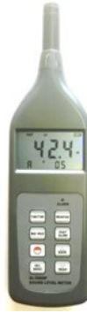
شکل ۲ دستگاه صوت سنج مدل SL-85868P مورد استفاده در این تحقیق منبع: نگارندگان
